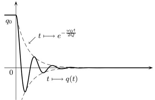
Il ressort de ces courbes que la charge  $q$  du condensateur tend vers 0 dans tous les cas, et même assez vite — décroissance exponentielle. Physiquement, cela veut dire que le condensateur se décharge. Dans cette situation de montage, le régime permanent n'est d'aucun intérêt : il ne s'y passe rien.
